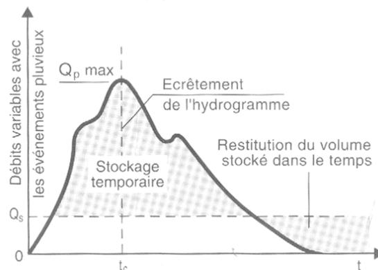
*Figure 1 : Principe de l'écrêtement d'un hydrogramme de crue*
